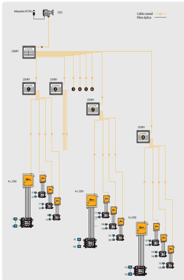
Nella progettazione di reti estese , caratterizzate da lunghe distanze e multiutenza l'uso della fibra ottica diventa indispensabile. Per situazioni in cui il passaggio cavi o il numero di conduttori cresce , la fibra ottica offre una valida alternativa a completamento o integrazione delle distribuzioni satellitari in coassiale.
